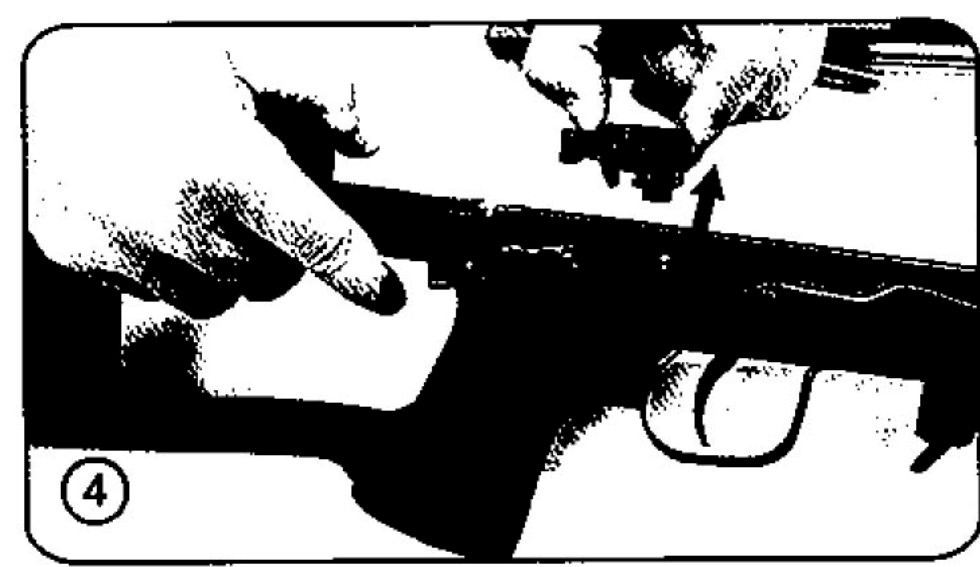
取出緩衝墊(※注意:槍機裝入時，緩衝墊也要放入，以免槍身受損)
